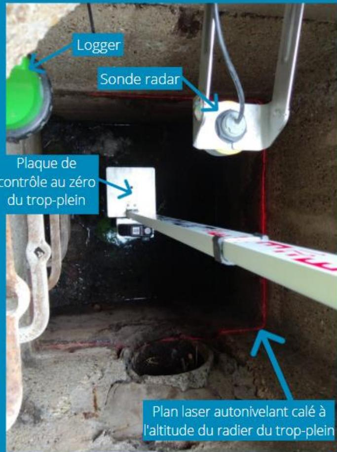
Contrôle de la mesure de hauteur d'eau
